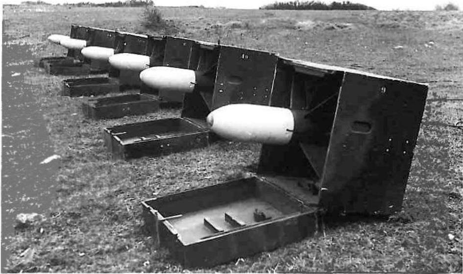
Missiles sol-sol SS10 prêts pour le tir.
